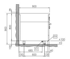
Electrical inlet (power) Equipotential screw
